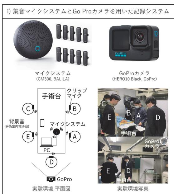
まず複数のクリップマイクを有するマイクシステムとGo Proによる動画記録を組み合わせたシステムを試作し、実際の救急初療を模して実験を行った(左図)。
