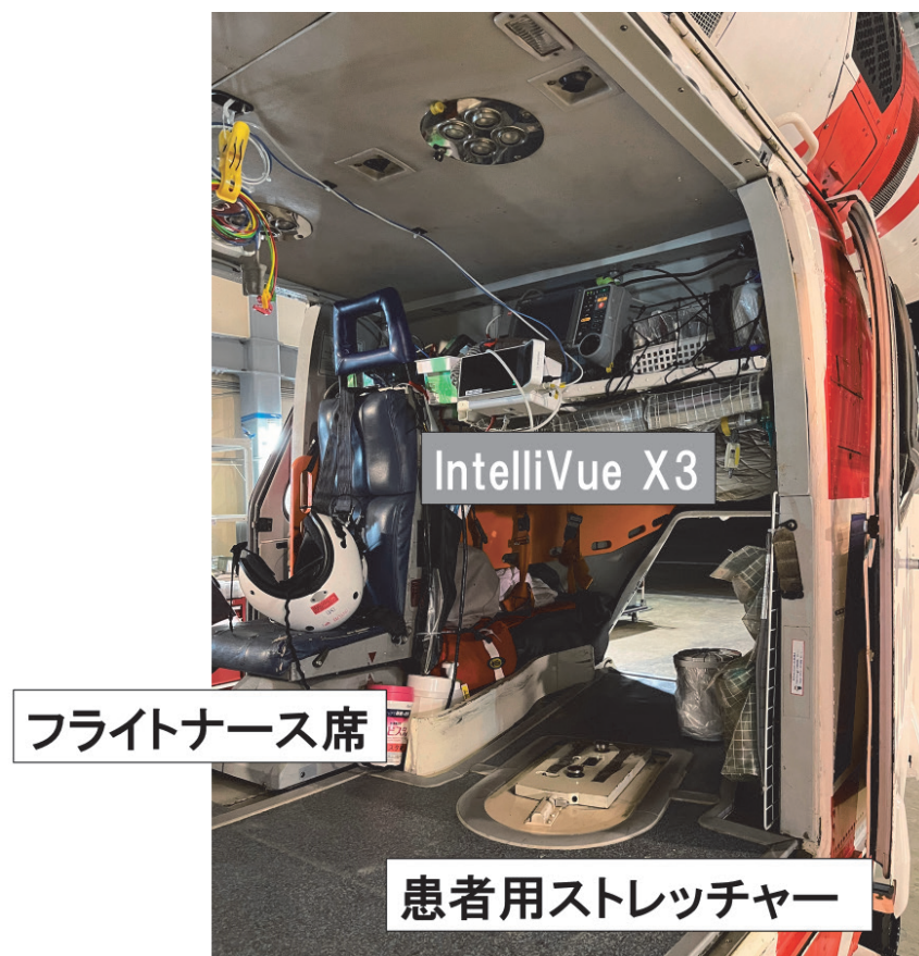
図4 Air-MTU実証実験における機内配置
