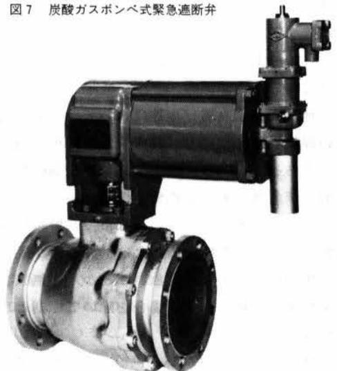
作動信号を与えるとカッターのロックが外れ、炭酸ガスボンベの封を切って炭酸ガスをシリンダー内に噴射し、ピストンならびにこれと連結する弁体を回転させることによってガス遮断を行う。
