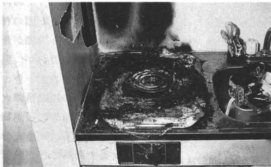
写真1 システムキッチンの電気コンロのスイッチが誤って入って出火した火災
