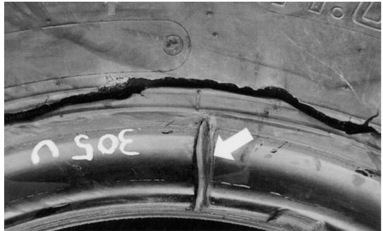
写真2 ビード部の損傷
