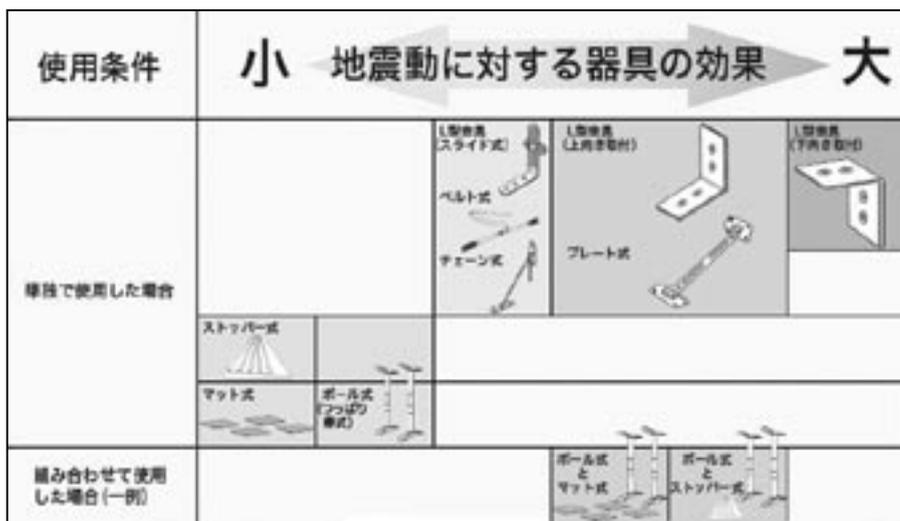
図6 転倒防止器具の振動実験による検証結果
