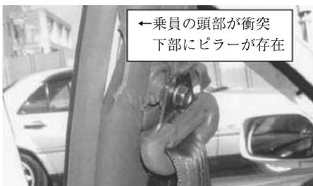
図5 シートベルト非着用の乗員が衝突した内装材
