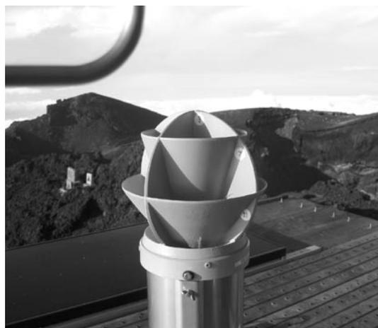
図6 3次元雨量計（富士山測候所での観測）
