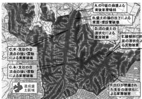
図3 仙台市泉区南光台で見られた家屋被害のパターン（盛土、切土の範囲は（株）復建技術コンサルタントの調査による）
