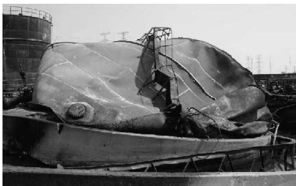
写真9 焼損したガソリンタンク
