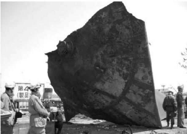
写真13 飛散したガスタンクの破片
