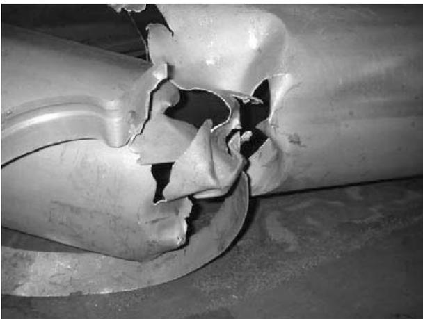
写真23 破断したフロートチューブ（直径25.4cm、長さ6.7056m）
