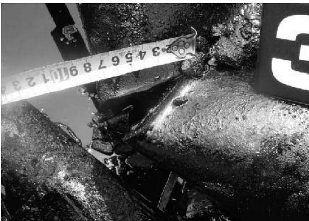
写真2 重油配管の開口部
