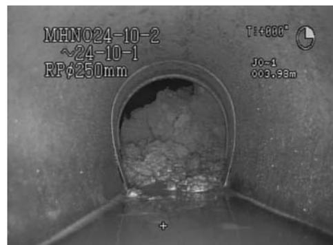
写真4 土砂流入による管の閉塞
